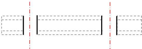
Mit ...**Palladium**..... wird nun die Lochwand auf den Kupfer-Endaufbau-Prozess vorbereitet. Leider scheidet sich Palladium nicht nur an jenen Stellen in der Lochwand, die aus FR4 sind ab, sondern auch am Kupfer der beider Außenlagen. Hier muss das Palladium aber vor dem Endkupferaufbau wieder entfernt werden. An Ende bleibt das Palladium nur in der Lochwand.
