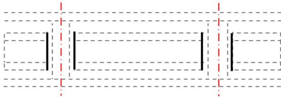
Um nun die Leiterbilder (Top- und Bottom-Layer) auf das Kupfer „kopieren“ und fertigen zu können, wird ....**Fotoresist**..... (ein blaue Folie) auflaminiert. Diese Folie wird vollflächig aufgebracht – sie überdeckt also auch die bereits gebohrten ...**Löcher**....!
